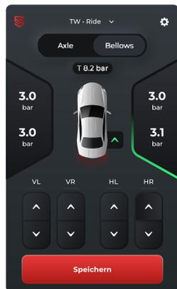
Einstellung eines neuen Fahrdrucks (ohne Höhensensoren)
