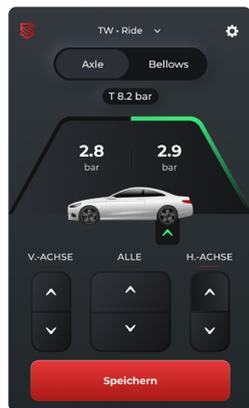
Einstellung eines neuen Fahrdrucks (ohne Höhensensoren)
