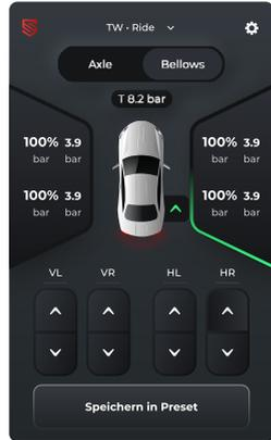
Manuelle Verstellung mit Anzeige von Druck und Höhe (mit Höhensensoren)
