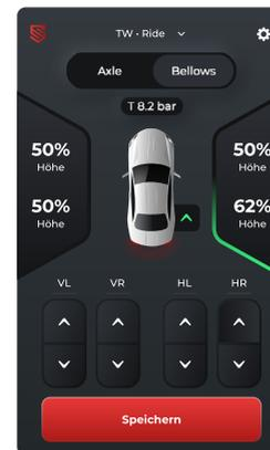
Einstellung einer neuen Fahrhöhe (mit Höhensensoren)
